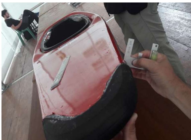
Illustrazione 1: Controllo dello spessore del bordo laterale
