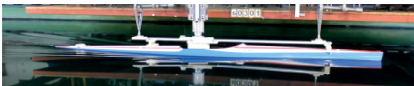
28 – Kayak inclinato di 0,5^\circ verso poppa V = 3 \text{ m/s}
