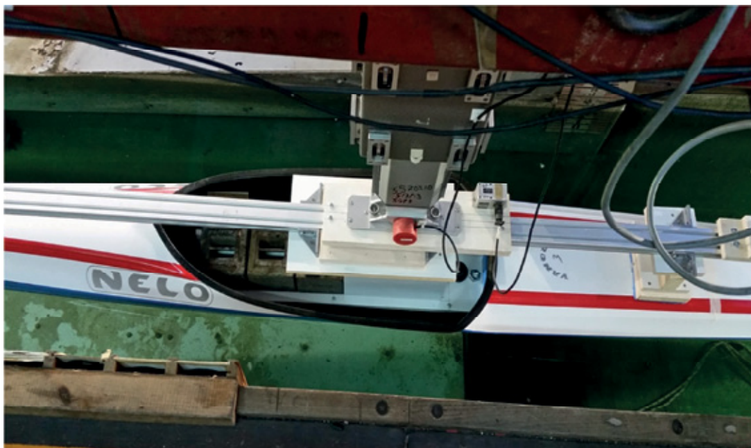
23 – Allestimento del kayak per la prova di rimorchio
