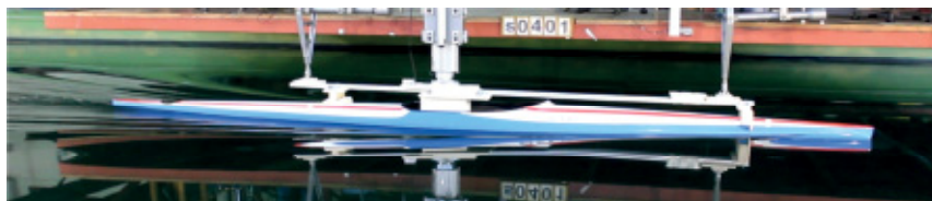
28 – Kayak inclinato di 0,5^\circ verso prua V = 3 \text{ m/s}
