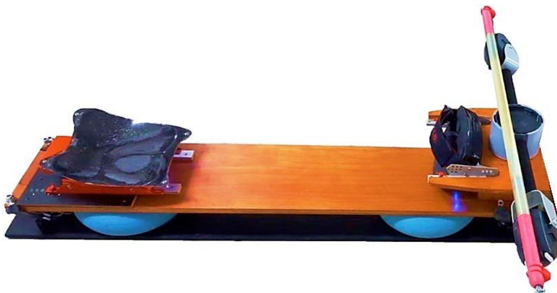
Figura 6. Posturo-ergometro montato su due supporti instabili
