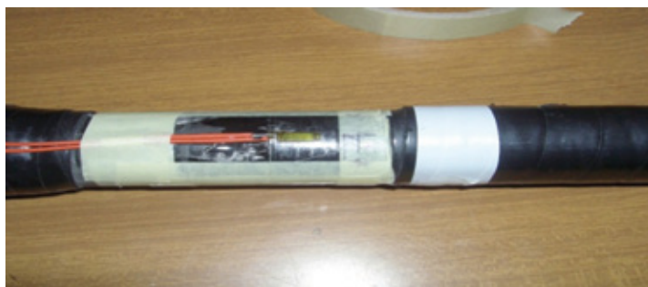
Figura 3 - Ponte estensimetrico sul manico della pagaia
