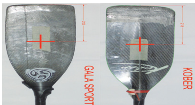
Figura 6 – Le pagaie utilizzate con la taratura della strumentazione.
