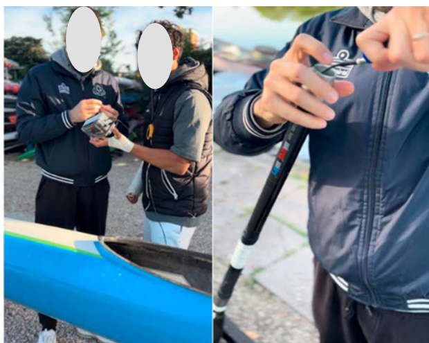
Figura 4 - Preparazione al test, posizionamento dell'IMU e sistemazione della pagaia strumentata
