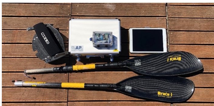
Figura 1: Schema di applicazione del Sistema "E-kayak": GPS, Global position system; IMU, Inertial Measurement Unit; S1, paddle; S2 footrest. (tratto da: Bonaiuto, V., Gatta, G., Romagnoli, C., Boatto, P., Lanotte, N., & Annino, G. (2020). A pilot study on the e-kayak system: A wireless DAQ suited for performance analysis in flatwater sprint kayaks. Sensors , 20(2), 542.).
