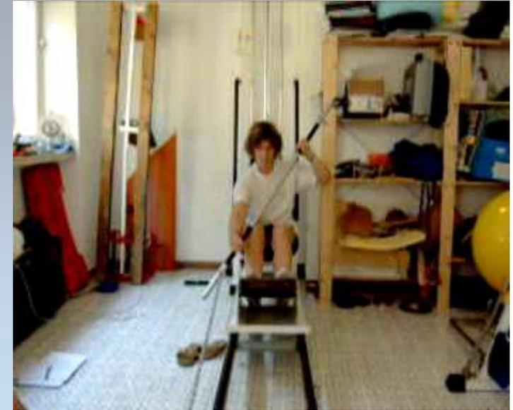
**La velocità è stata calcolata tramite uno strumento ERGOSPEED, un encoder lineare, un contatore che segnala lo spostamento e il tempo e di conseguenza la velocità**
