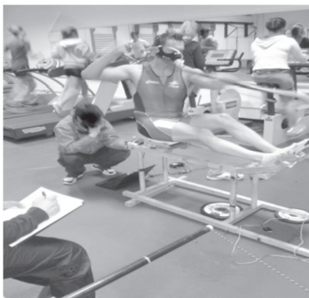
Figura 1. La fotografia mostra uno dei soggetti in studio mentre indossa il VO2000 durante il test in laboratorio e durante il test in kayak.
