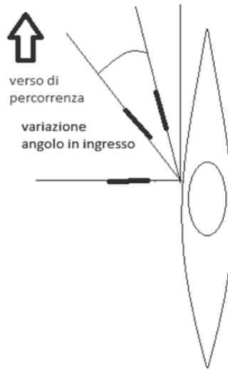
Figura 9 -Illustrazione di come varia l'angolo della pala in acqua durante il colpo per il soggetto testato.
