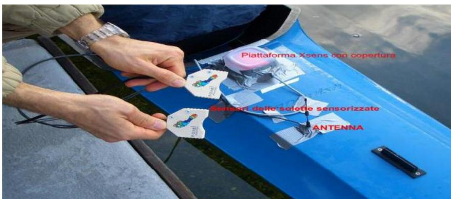
Immagine 1 - Piattaforma inerziale Xsens montato sulla coperta dell'imbarcazione, sensori delle solette sensorizzate e antenna per invio dei dati in telemetria.
